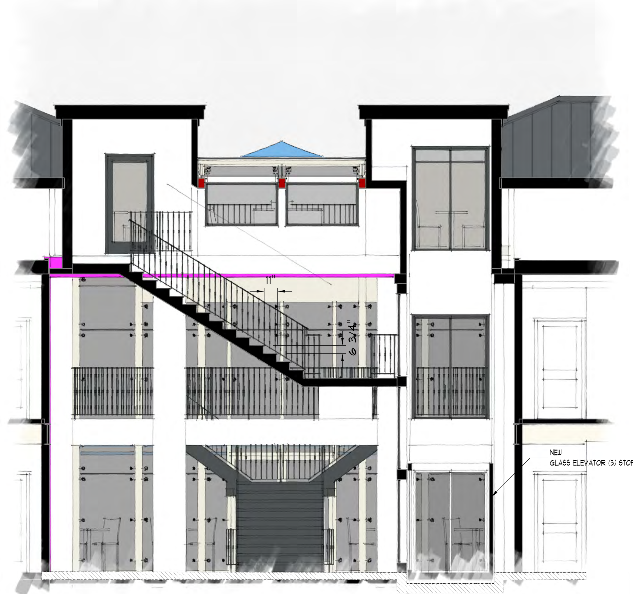
All: 3 X6 "L" @ N. TERR. STAIR/EGRESS SCALE: 1/4" = 1'-0"
