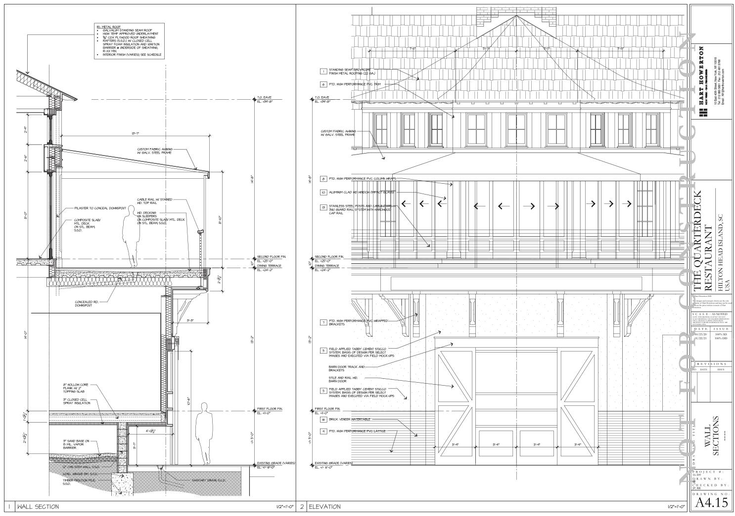
sale, H\;2016/16519 Quartedeck Restauran\;3.0 CAD\Sheetfles\16-519\_QD\_A4.15 dwg. Page Setup:----, HH-CDs.eth, Plot Scale 1:1, \_DWG To PDF with Layers pc3
