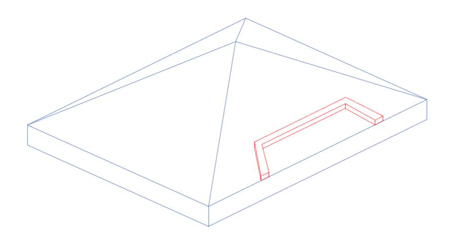
> INSTALL FULLY AHERED TPO SINGLE-PLY MEMBRANE (SINGLE FACET INSTALL)
